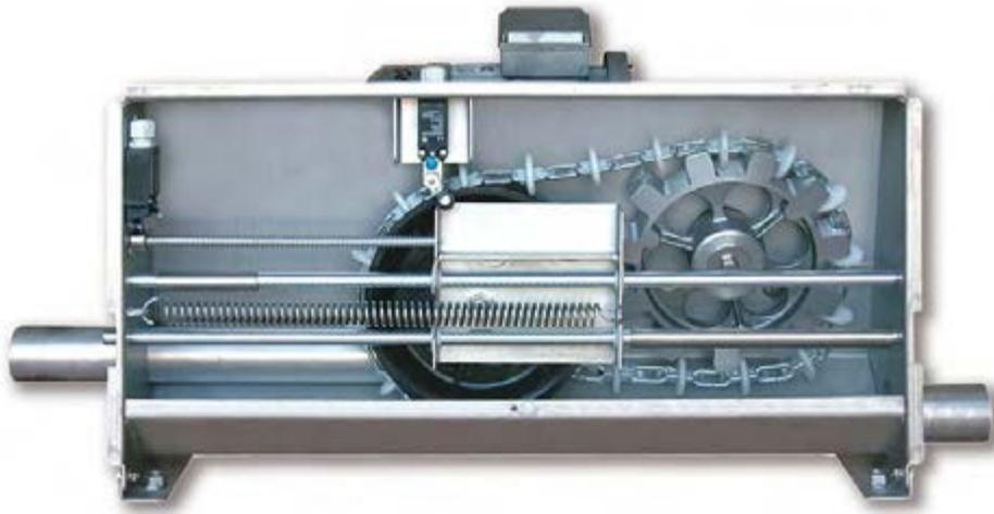
🇩🇰 Anlæggets trækstation leveres som 1-banet fodermaskine, og optagerstationen kan leveres som både 1- eller 2-banet, evt. med separat foderfremføring. Der kan tilkobles sneglefremføring til kædetræk, som aktiveres ved kædens fremdrift. I optagerstationen (1-banet, med foderfremføring) er der en indbygget stenfælde, som sikrer anlægget mod diverse fremmedlegemer.
